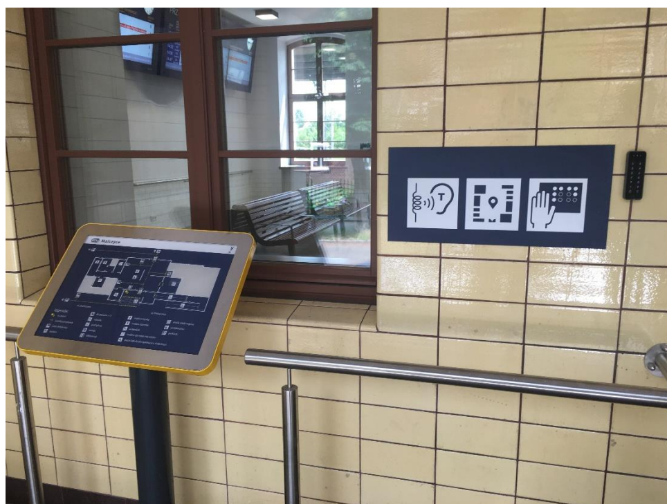
Rysunek 20. Tyfłomapa oraz oznaczenia wyposażenia w pętlę indukcyjną na dworcu
