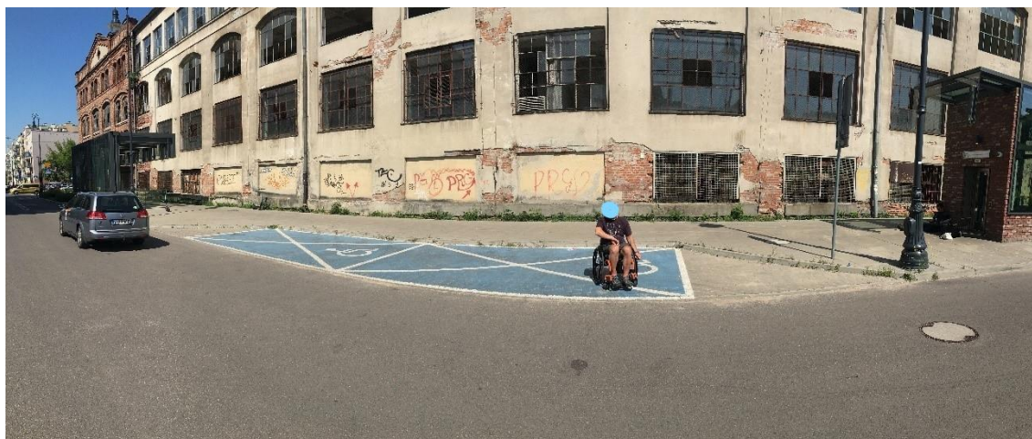
Rysunek 22. Miejsce parkingowe przy stacji - brak obniżenia krawężników uniemożliwia osobom na wózku wjechanie na chodnik i dotarcie do wejście na stację metra
